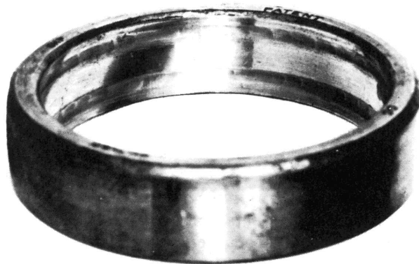
그림 3-56 베어링 회전시 윤마물이 있는 상태에서 진동으로 인한 폴스 브리넬링
