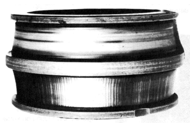
그림 3-64 구형 롤러 베어링 내륜 궤도면에 발생한 플러팅
