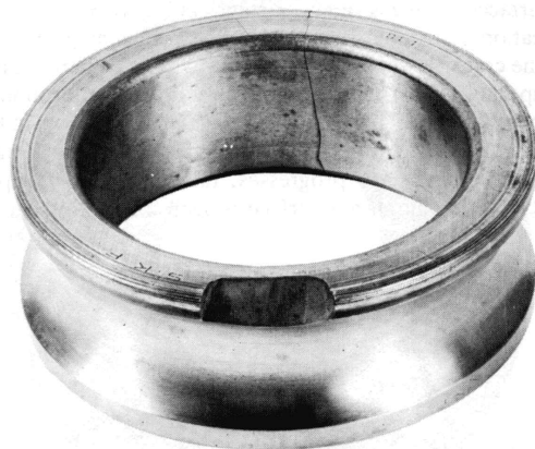
그림 3-34 과도한 간섭 맞춤에 의한 축방향 균열
