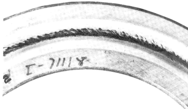
그림 3-22 볼스러스트 베어링의 Smearing
