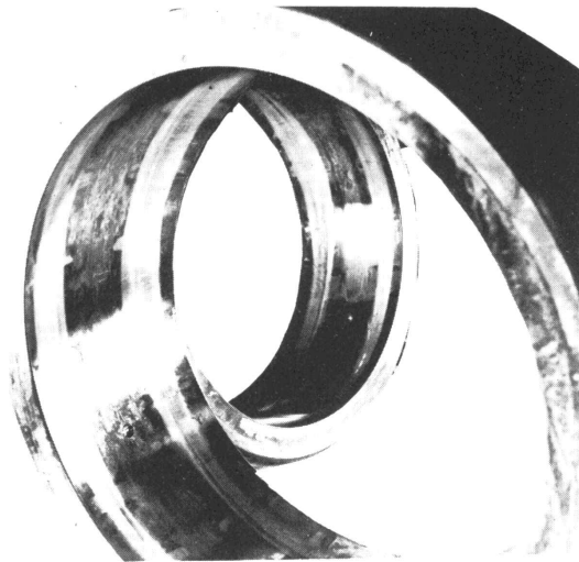
그림 3-16 하우징에 꼭끼어진 구형 롤러 베어링 외륜의 거울상
