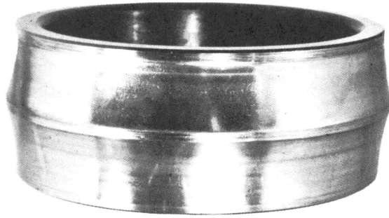
그림 3-25 프래그먼트 덴팅(Fragment Denting)
