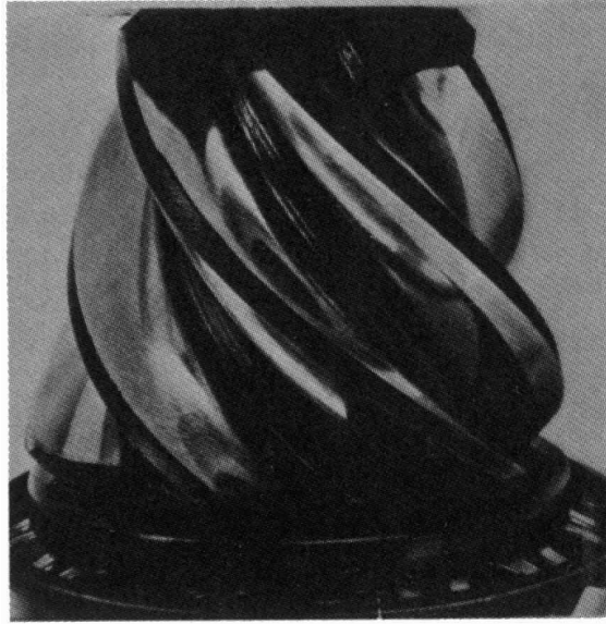
그림 3-103 폴리싱. 주행 상태의 경화된 하이포이드 피니언의 표면은 고도의 폴리싱 표면을 나타내고 있다. 윤활제내의 고압 첨가제는 이빨 표면의 폴리싱을 촉진시키는 경향을 갖는다.
